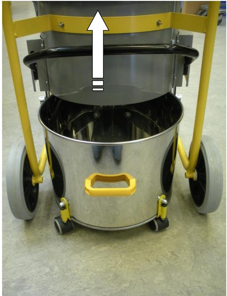
Um den Behälter zu montieren, wird er unter das Gerät gerollt, bis er vom Führungsrand vorne am Gerät gefangen wird.
