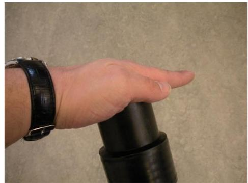
Jetzt wird volles Vakuum im Gerät aufgebaut.
