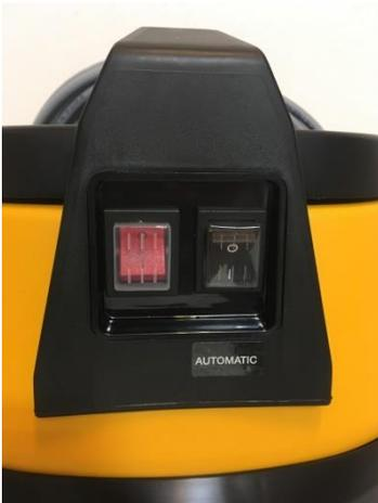
Die Ein-/und Ausschaltautomatik wird mit dem schwarzen Schalter am Motorkopf ein- und ausgeschaltet. Wenn die Ein-/und Ausschaltautomatik betätigt ist, schaltet die Maschine nicht ein, wenn man auf den roten Schalter drückt. Die Maschine wird nicht eingeschaltet, bevor das eingeschaltete Handwerkzeug eingeschaltet wird.
