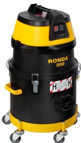
Wenn die Maschine korrekt montiert und angeschlossen ist, kann sie mit dem roten Schalter des Motorkopfes eingeschaltet werden. Die Maschine ist mit einem Alarm ausgestattet, der einen zu niedrigen Luftdurchfluss für Aufsaugen anzeigt. Dieser Alarm muss vor Gebrauch überprüft werden. Das Ansaugen am Ende des Schlauches abblenden. Die Maschine fängt an zu piepen. Die Abblendung entfernen, und der Piepser stoppt.
