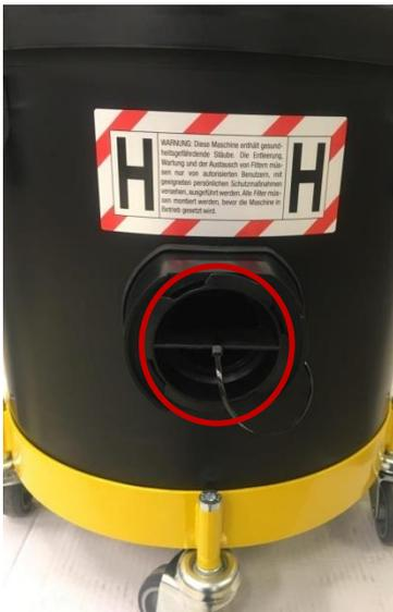
Der Behälter ist mit einem Stopfen versehen, den beim Transport und Stillstand der Maschine verwendet werden muss.
