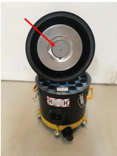
Die vier Behälterklammern, die den Motorkopf festhalten, lösen, und den Motorkopf so anbringen, dass zum Filter Zutritt ist.
